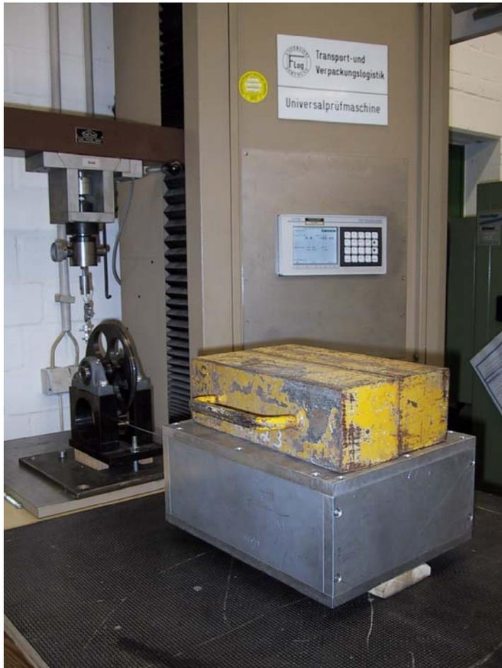
*Abbildung 3-1: Versuchsstand zur stationären Ermittlung von Reibbeiwerten mit Prüfmodellen*
