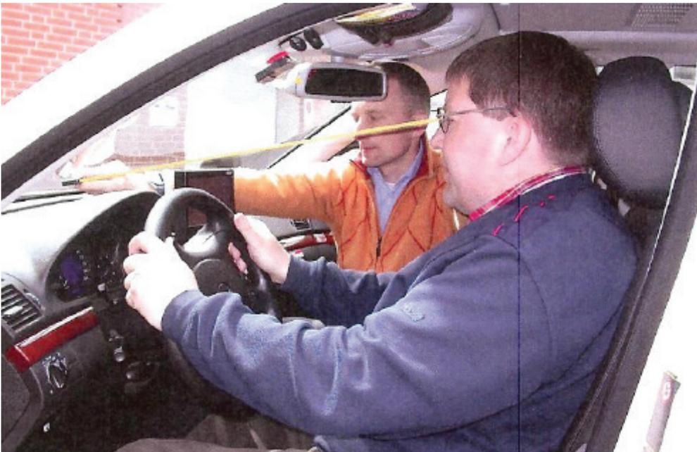
Abb. 4: Bei der Prüfung wird die Sichtlinie des Fahrers vermessen.
