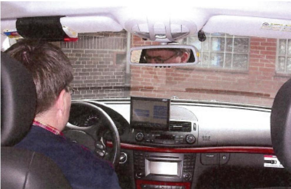
Abb. 3: Monitor im Bereich der Mittelkonsole stellt keine Sichtfeldeinschränkung dar.
