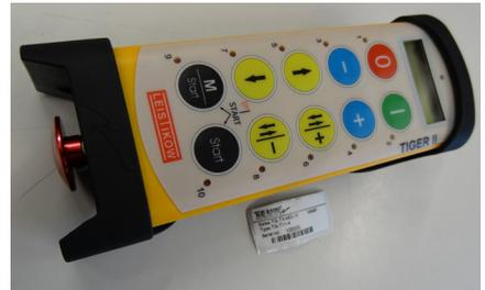
Funksteuerungen mit Folientastatur und Not-Halt-Funktion
