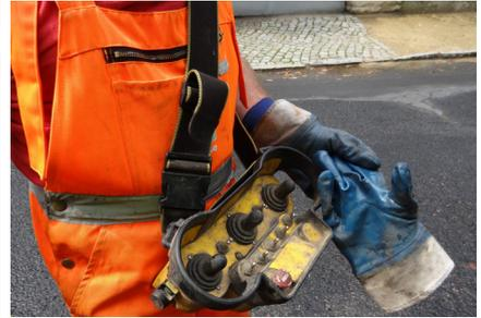
Beispiele für die Gestaltung von Bedienelementen und Tragemöglichkeiten am Sender der Funkfernsteuerung
