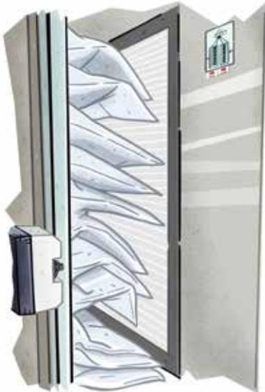
Abb. 12: Ein flächiger Kontakt von Filtern mit dem Kammerboden muss vermieden werden.
