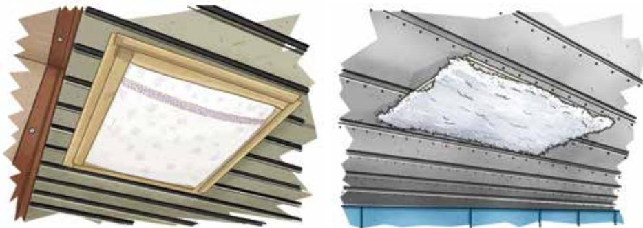
Abb. 10: Zulüfter mit Wischklappen (links) bzw. Zulüfter mit Filtermaterial (rechts)
