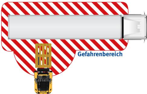
Beispiel einer Ladeanweisung bei beidseitiger Öffnung des Fahrzeugaufbaus
