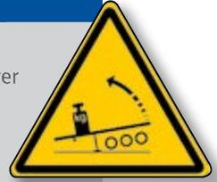
Sattelanhänger nur auf Untergrund mit ausreichender Tragfähigkeit absetzen. Erforderlichenfalls Stützen zur Vergrößerung der Aufstandsfläche (entsprechend der Tragfähigkeit des Untergrundes) unterlegen.
