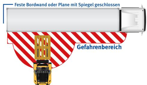
Beispiel einer Ladeanweisung bei einseitiger Öffnung des Fahrzeugaufbaus
