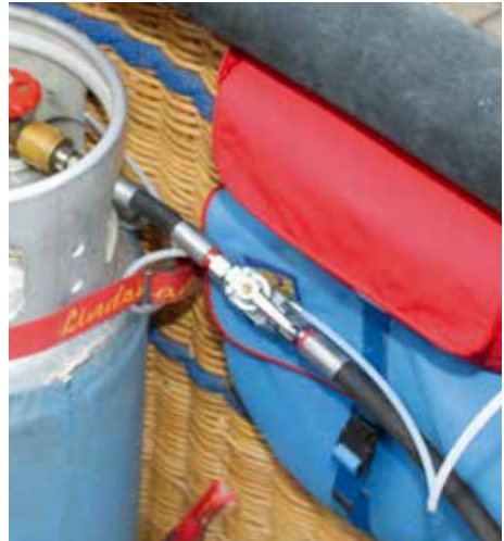
Sicheres Ableiten des austretenden Gases
