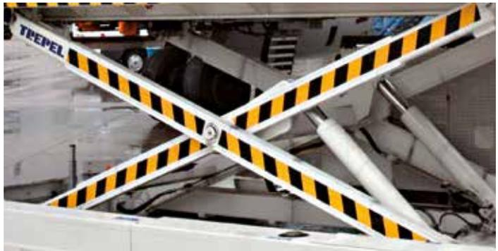
Gefahrstelle an einer Hubvorrichtung
