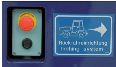
Rückfahreinrichtung mit Drucktaster
