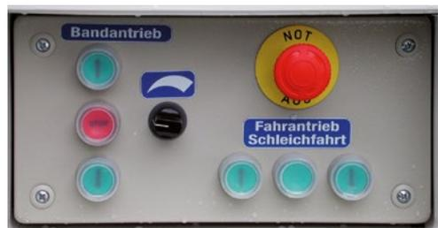
Befehleinrichtung und Not-Halt-Taster
