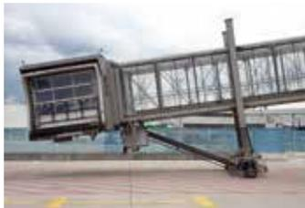
Fluggastbrücke mit Fahrwerk
