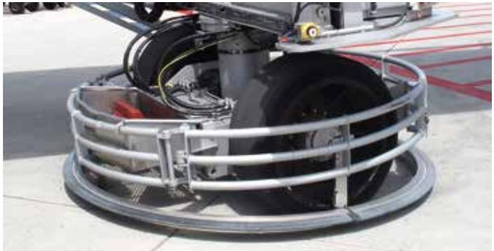
Fahrwerk mit Kontaktleiste und Abweisbügeln
