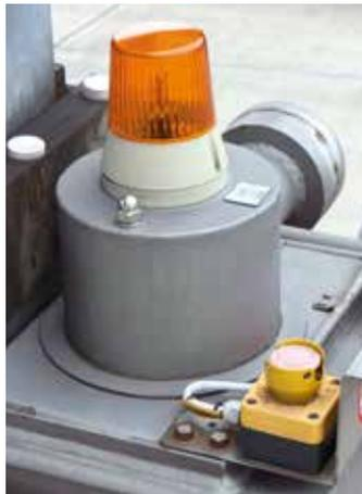
Warnleuchte und Notbefehlseinrichtung am Fahrwerk
