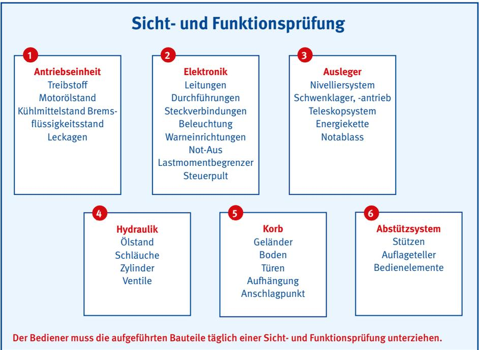
Bild 5-1 Tägliche Sicht- und Funktionsprüfung
