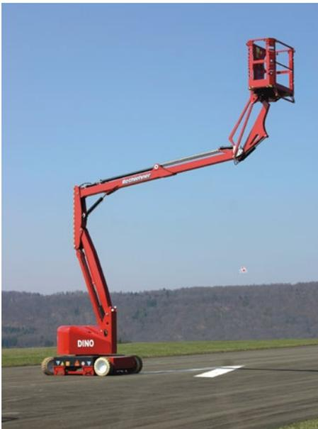
Bild 3-4 Gelenkteleskopbühne Typ 3B
