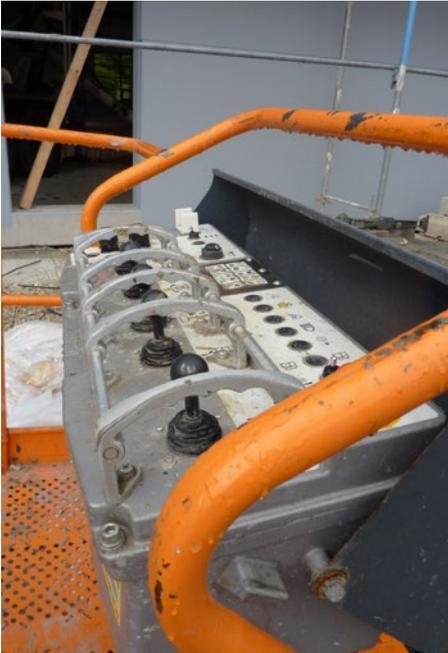
**Bild 6-3** Schutzbügel gegen unbeabsichtigtes Betätigen der Bedienelemente
