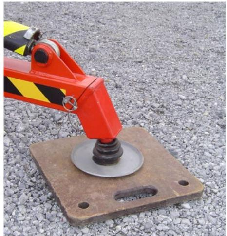
Bild 4-4 Positionierung der Stützfüße auf der Unterlegplatte
