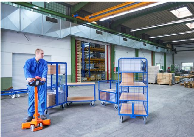
Abb. 10 Routenzug mit Steherschlepper und verschiedenen Anhängerformen
