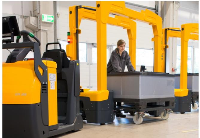
Abb. 21 Ergonomisches Entladen im Routenzug mit Durchschieben der Last
