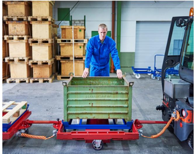
Abb. 20 Einschieben von Bodenroller in den Routenzug
