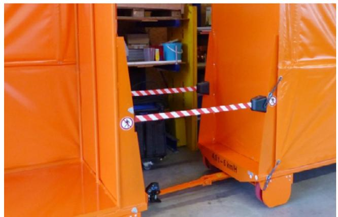
Abb. 25 Durchtrittsicherung bei Routenzügen
