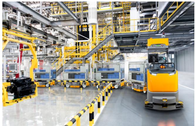
Abb. 5 Produktionsversorgung mit einem fahrerlosen Routenzug
