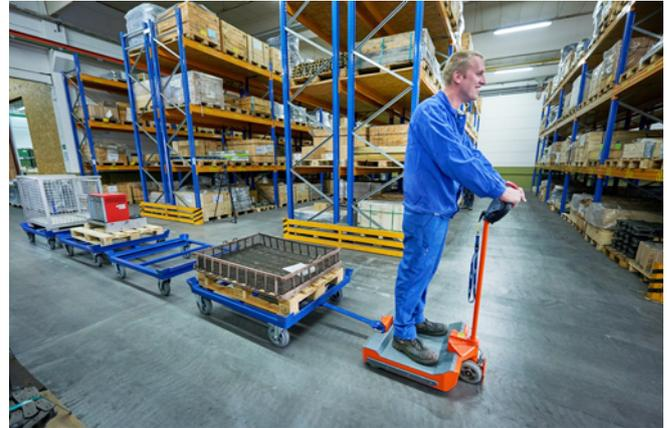
Abb. 2 Routenzug mit Stehschlepper und Palettenfahrrahmen
