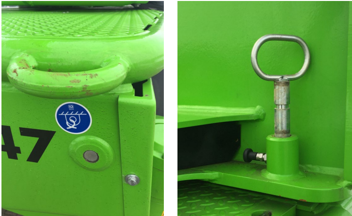
Abb. 8.9 Zurr-Öse zur Ladungssicherung (links) und Drehkranzarretierung (rechts)
