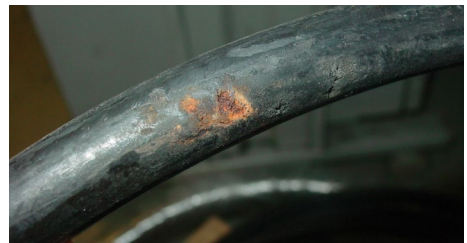
Abb. 10.1 Defekte Hydraulik-Schlauchleitungen sofort ersetzen
