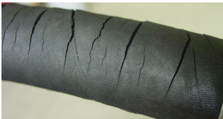
Abb. 10.1 Defekte Hydraulik-Schlauchleitungen sofort ersetzen
