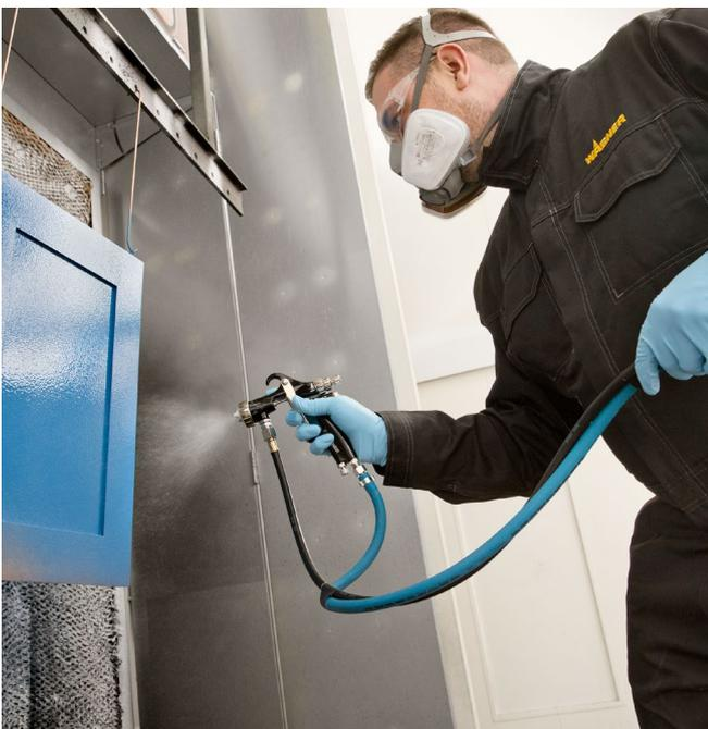
Abb. 26 Lackierarbeiten an einem Spritzstand
