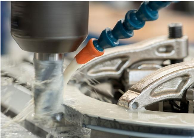
Abb. 23 Kühlschmierstoffanwendung an einer Drehbank
