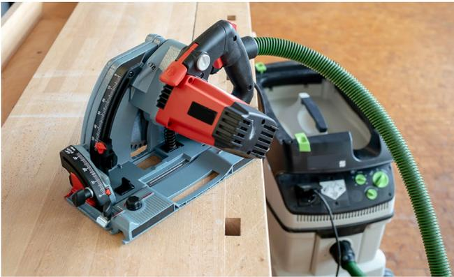
Abb. 13 Handgeführtes Elektrowerkzeug mit Absaugung über ortsveränderlichen Entstauber
