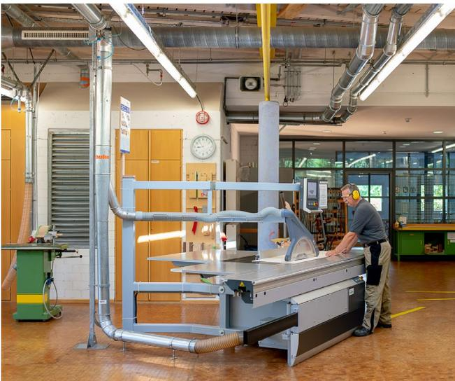
Abb. 11 Formatkreissäge mit abgesaugter Schutzhaube und Absaugung unterhalb des Tisches
