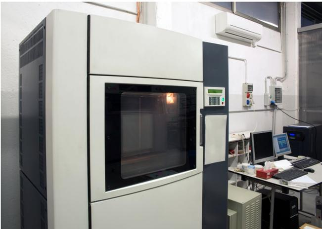
Abb. 39 Anlage für ein pulverbettbasiertes Schmelzverfahren
