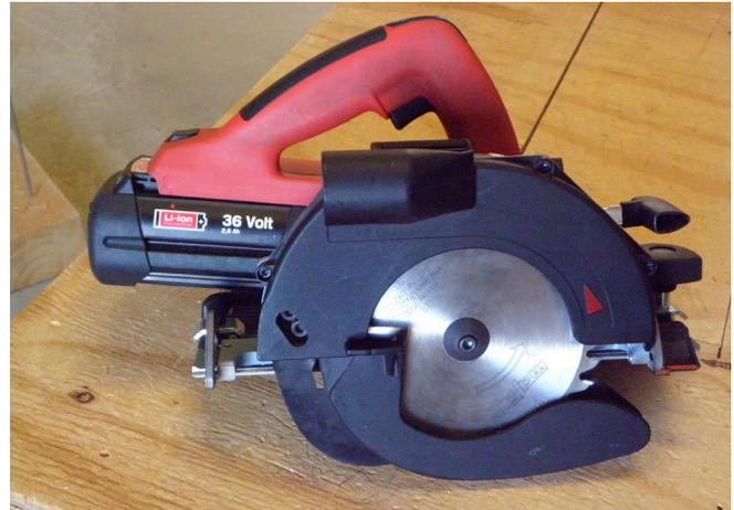
Abb. 43 Mit Lithium-Ionen-Akkus betriebene Akkuhandkreissäge
