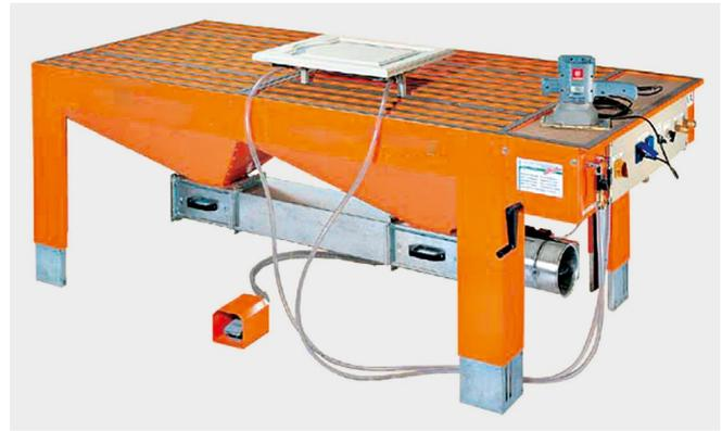
Abb. 14 Abgesaugter Arbeitstisch
