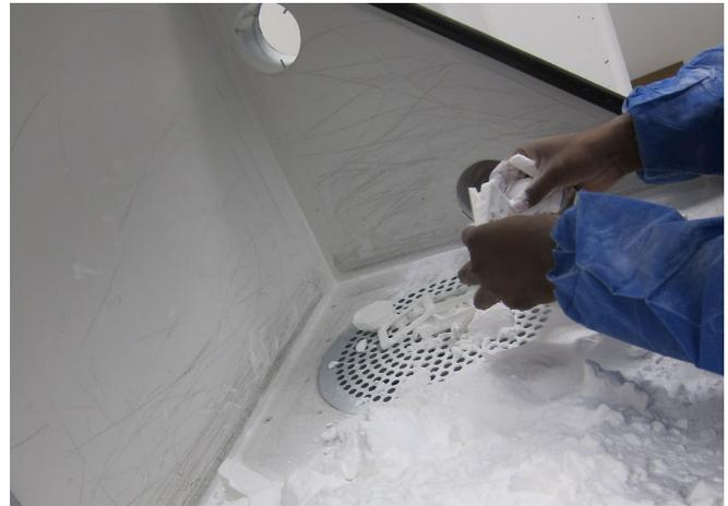
Abb. 40 „Auspacken“ der generierten Bauteile beim pulverbettbasierten Schmelzen
