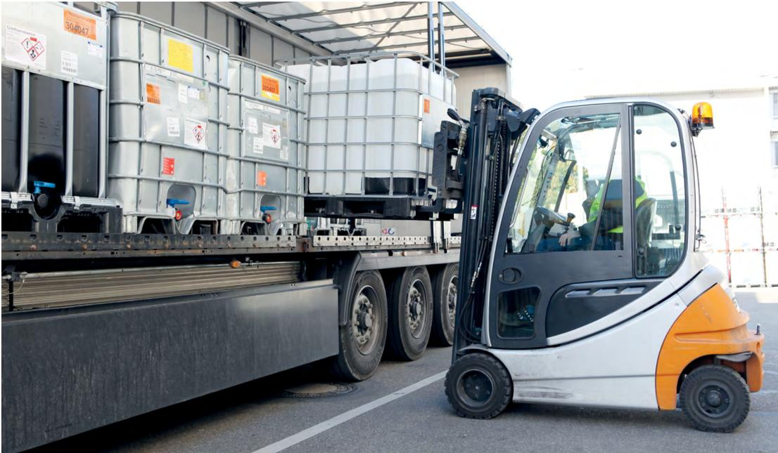
Abbildung 3: Entladen eines Lkws mit IBC
