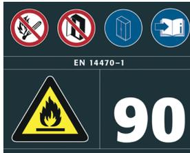
Abbildung 9a: Beispiel der Kennzeichnung von Sicherheitsschränken für brennbare Flüssigkeiten
