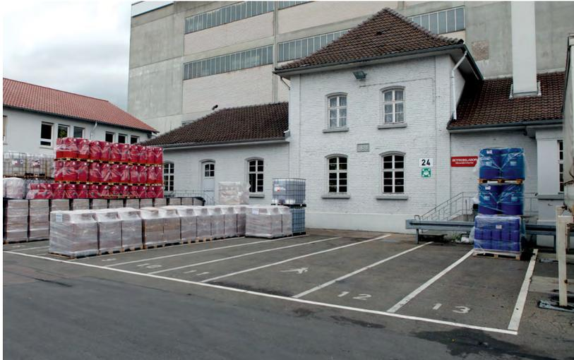
Abbildung 1: Lagerung von Gefahrstoffgebinden im Freien mit Abstand zwischen den Reihen
