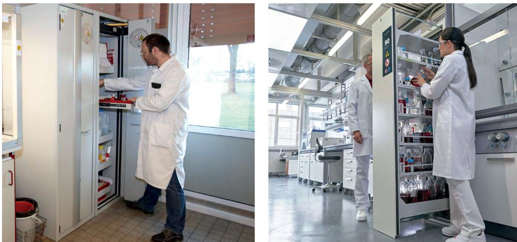
Abbildung 7: Sicherheitsschränke für brennbare Flüssigkeiten nach DIN EN 14470-1
