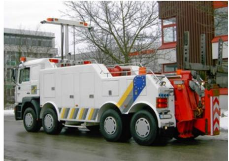
Abb. 2 Abschleppwagen (Unterfahrlift (AWU))
