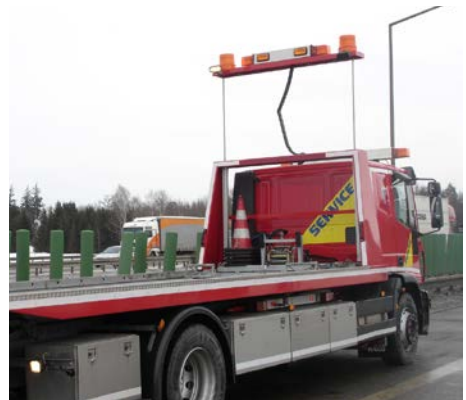
Abb. 7 Teleskopierbare, weit sichtbare Warnleuchten
