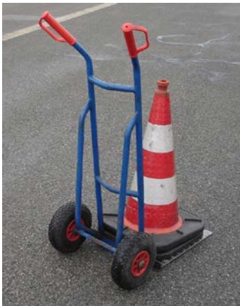
Abb. 11 Transportkarre für Leitkegel
