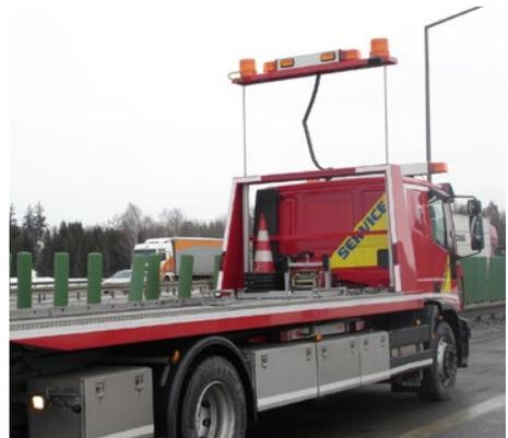
**Abb. 7** Teleskopierbare, weit sichtbare Warnleuchten
