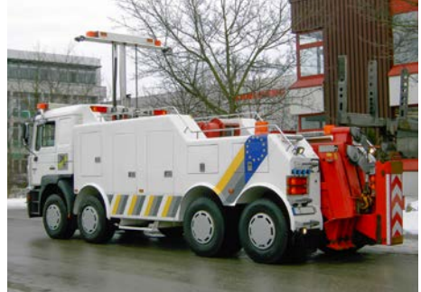
Abb. 2 Abschleppwagen (Unterfahrlift (AWU))
