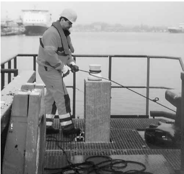
Abbildung 2: Rückenschonende Spillkopf-Ausführung Durch Verwendung solcher Spillköpfe kann die rückenbelastende Tätigkeit beim Einholen der Wurfleine reduziert werden.
