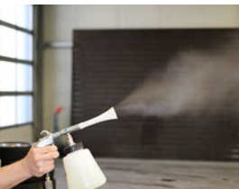
Abb. 20 Druckluftimpulsreinigungspistole im Einsatz
