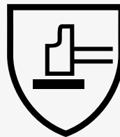
Abb. 24 So gekennzeichnete Handschuhe sind nicht geeignet für den Umgang mit Isocyanaten
