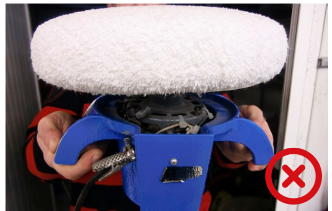
Abb. 3 Poliergerät in dieser Form in der EU nicht zugelassen, CE-Kennzeichen fehlt
