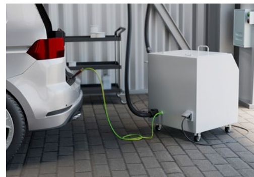
Abb. 19 Geerdetes Fahrzeug/Potentialausgleich beim Einsatz des TESTG
