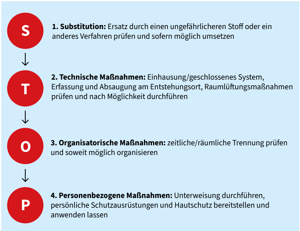
Abb. 12 Achten Sie im Zusammenhang mit Gefahrstoffen auf die Rangfolge der im STOP-Prinzip vorgegebenen Schutzmaßnahmen
