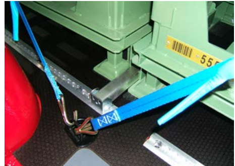
Kombinierte Ladungssicherung im Kastenwagen
