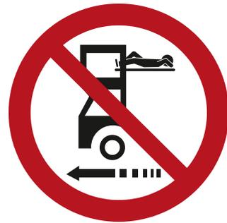
Abb. 8 Verbotsschild „Verbot des Aufenthalts in Dachschlafkabinen während der Fahrt“ nach DIN 70006-1
