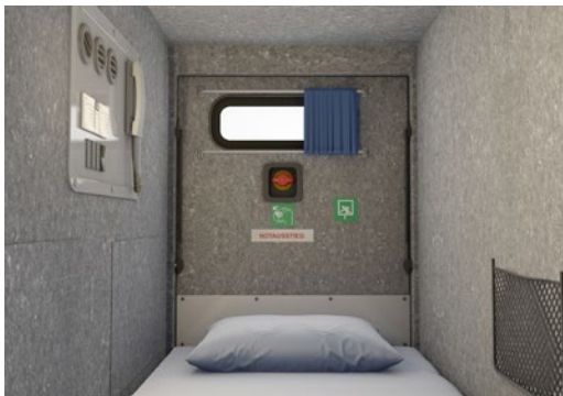
Abb. 13 Notausstieg mit Fenster
