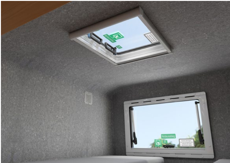
Abb. 10 Zweiter Notausstieg in der Dachfläche
