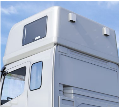
Abb. 8 Sicherheitsbelüftung der Dachschlafkabine
