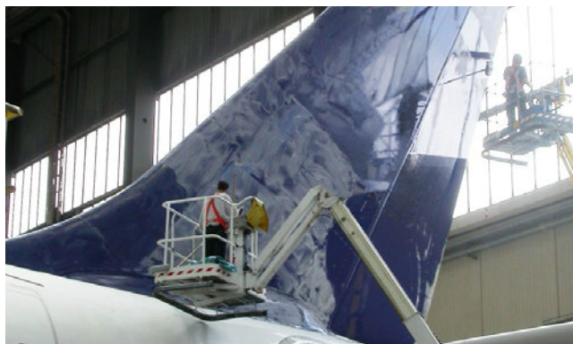
Abb. 98 An hochgelegenen, schwer zugänglichen Bauteilen darf nur mit Absturzsicherung gearbeitet werden
