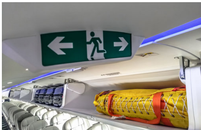
Abb. 80 Verpackte Rettungsinsel für Notwasserung
