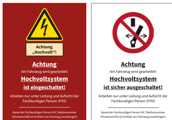
Abb. 93 Beispiele für die Kennzeichnung von HV-Fahrzeugen in der Werkstatt nach DGUV Information 209-093
