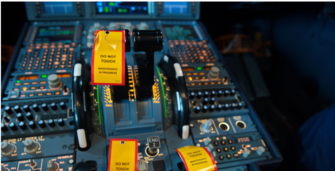
Abb. 65 Ein auffälliger Hinweis warnt vor dem unzulässigen Betätigen entsprechender Stellteile
