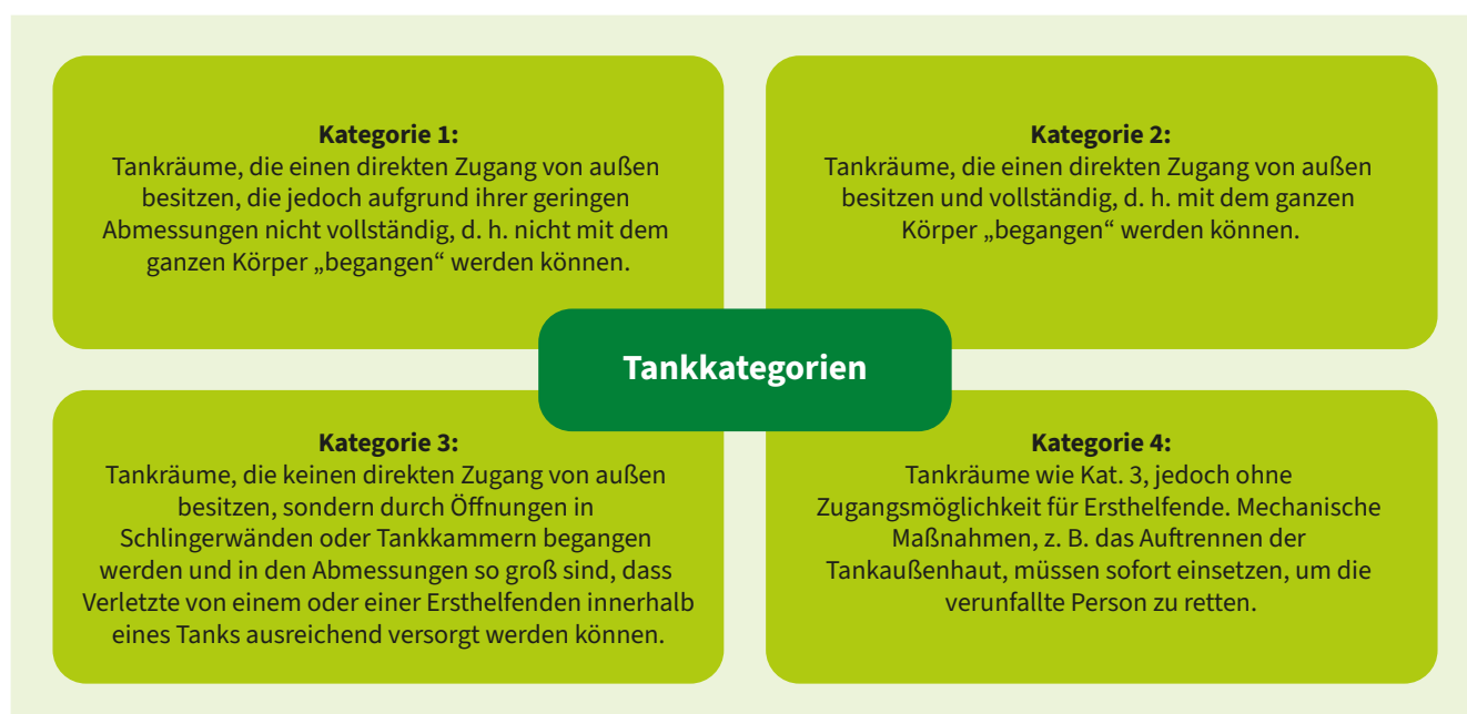
Abb. 62 Anhand der vier Tankkategorien werden die Schutzmaßnahmen festgelegt
