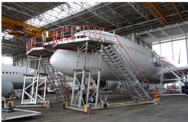
Abb. 34 Für die Dauer der Liegezeit müssen alle Arbeitsbereiche sicher erreicht werden können
