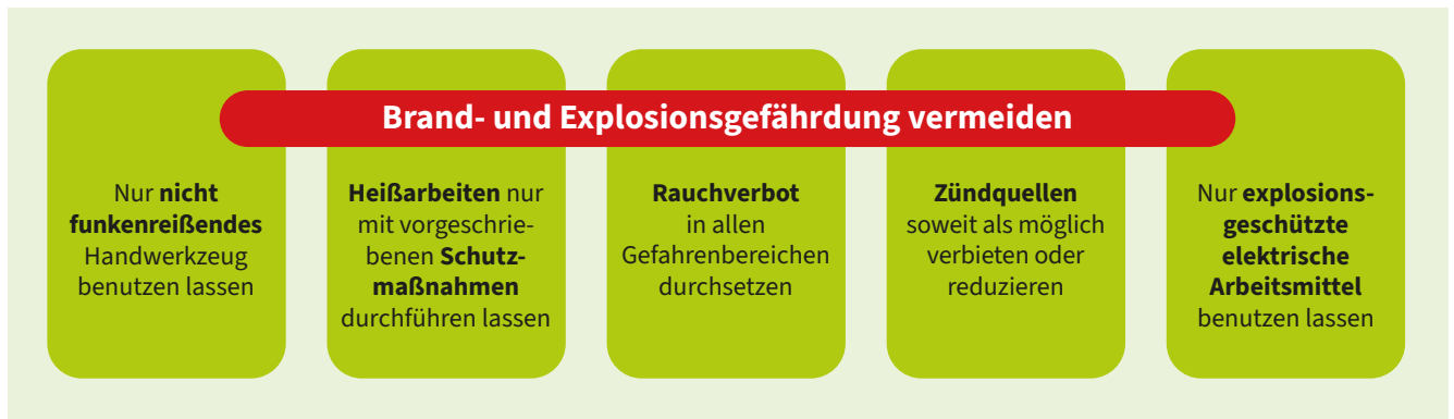
Abb. 58 Brand- und Explosionsgefahr möglichst zuverlässig ausschließen
