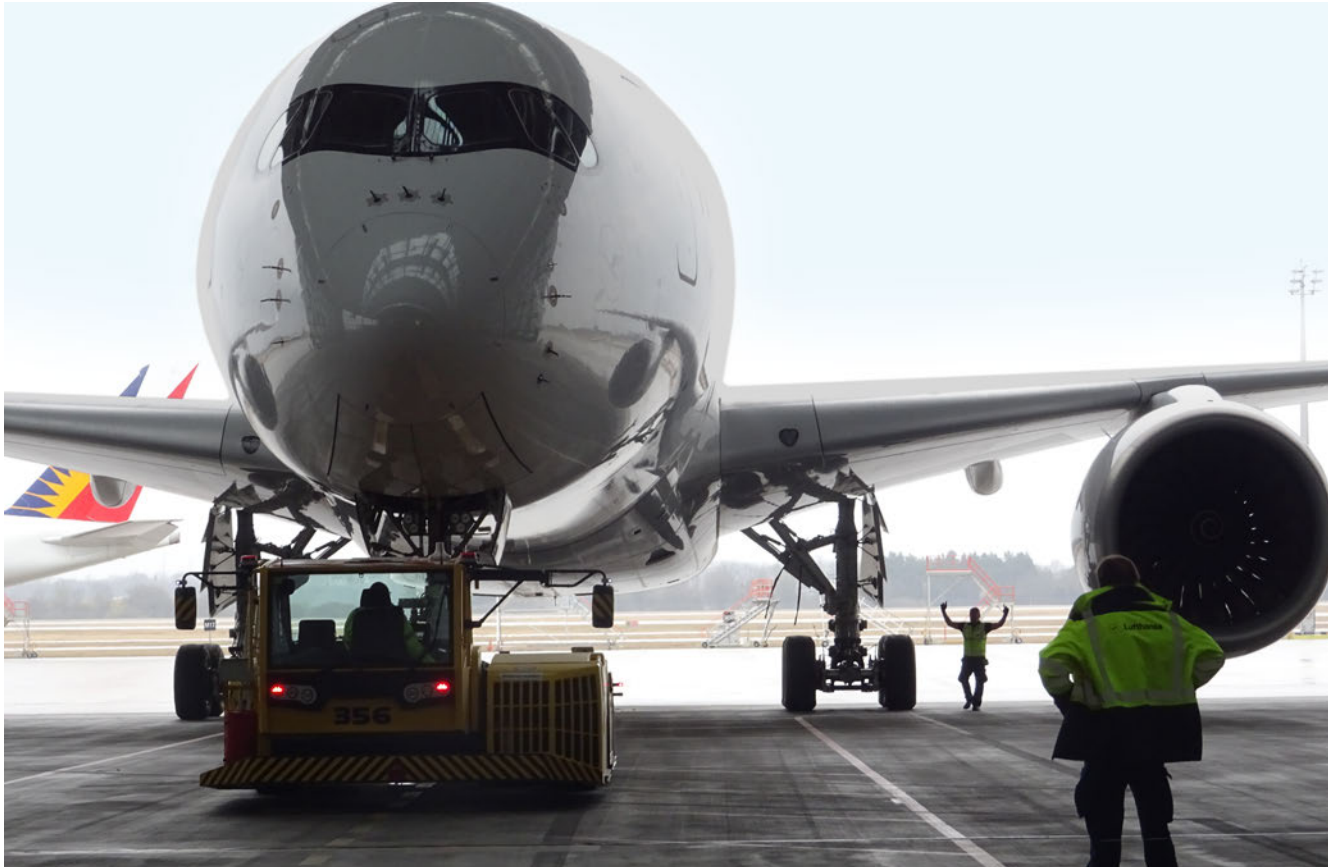
Abb. 86 Der Wing Watcher achtet auf einen hindernisfreien Verfahrbereich
