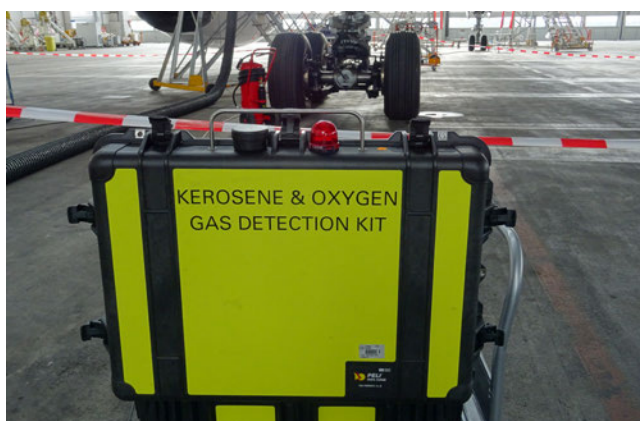
Abb. 57 Stellen Sie geeignete Gaswarngeräte bereit
