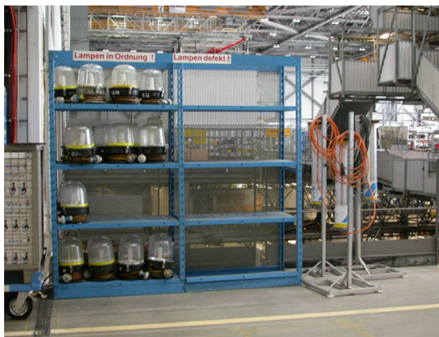
Abb. 13 Achten Sie auf getrennte Lagerung von einsatzbereiten und defekten Arbeitsmitteln
