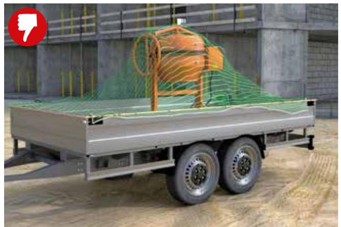
**Abb. 13** Zur Ladungssicherung ungeeignetes Abdecknetz
