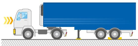
2. Sattelzugmaschine unter den Anhänger fahren und mittels Luftfederung anheben, bis ein Kontakt zwischen Kupplungs- und Aufgleitplatte besteht
