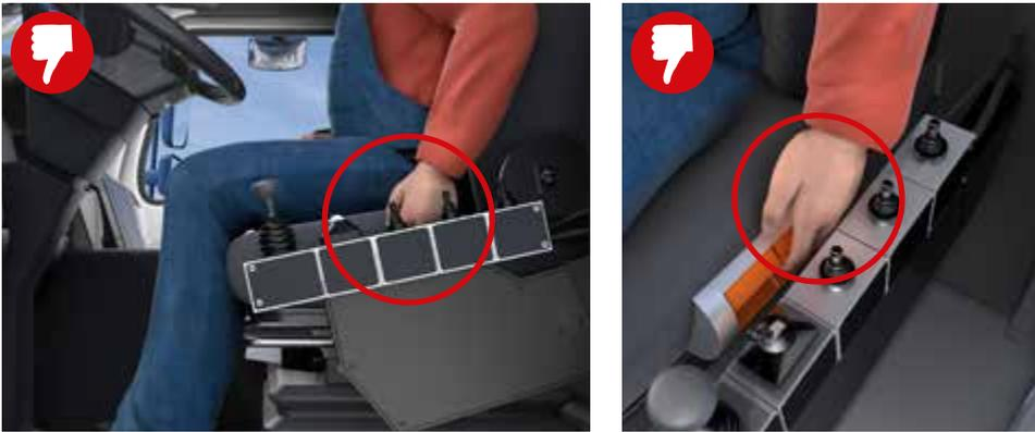
Abb. 18 Klemm- bzw. Quetschstellen bei nachträglich eingebauten Betätigungseinrichtungen
