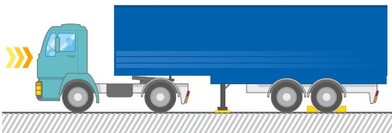
3. Zugmaschine zum Kuppeln einfahren, anschließend anrucken
