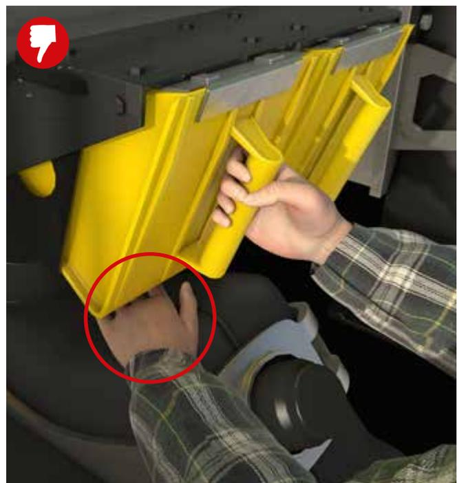
Abb. 5 Quetschgefahr bei der Entnahme von Unterlegkeilen
