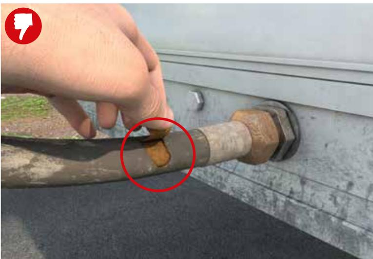
Abb. 31 Defekte Hydraulik-Schlauchleitung
