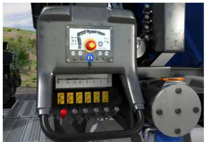
Abb. 28 Steuereinrichtungen mit Wahlschalter und NOT-HALT an Lkw-Ladekran
