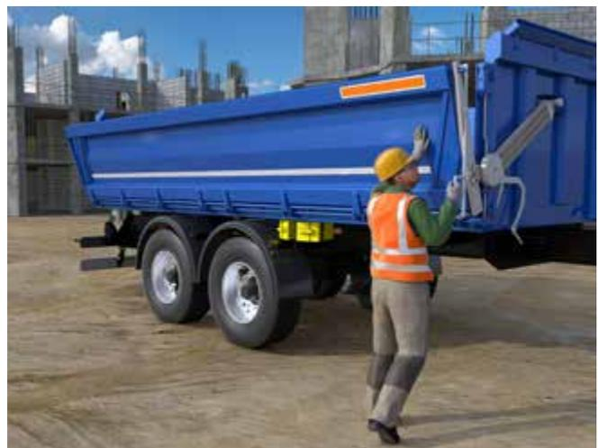
Abb. 22 Federentlastung für die seitliche Bordwand
