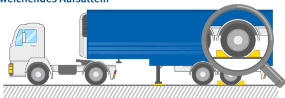
1. Kontrolle, ob Sattelanhänger mit Feststellbremse und Unterlegkeilen gegen Wegrollen gesichert sowie die Sattelkupplung geöffnet ist
