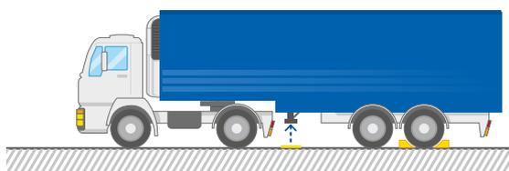
5. Zugmaschine zum Kuppeln einfahren, anschließend anrucken
