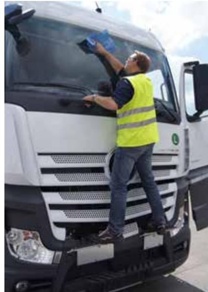
Abb. 16 Aufstieg zur Reinigung der Frontscheibe
