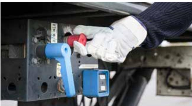
Abb. 65 Betätigen der Feststellbremse am Sattelanhängern
