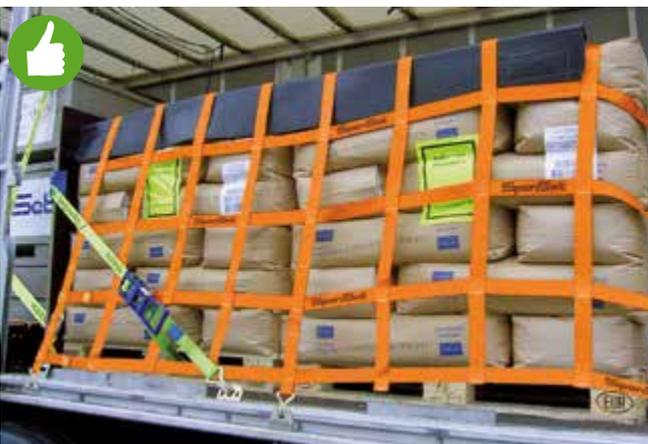
**Abb. 12** Geeignetes Ladungssicherungsnetz
