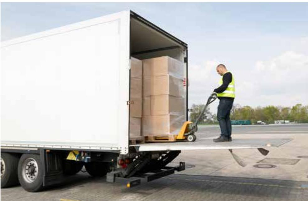
Abb. 77 Ladetätigkeiten mit Hubladebühne
