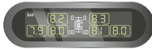
Abb. 6 Reifendruckkontrollsystem
