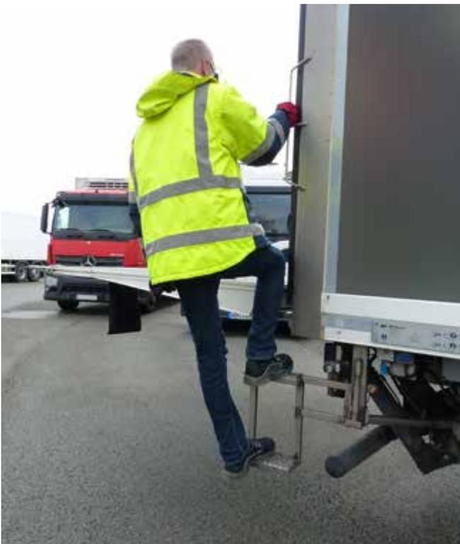
Abb. 29 Schwenkbarer Aufstieg zur Hubladebühne
