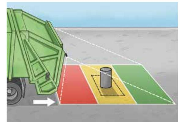
Abb. 2: Sichtbereich des Kamera-Monitor-Systems mit detektiertem Prüfkörper
