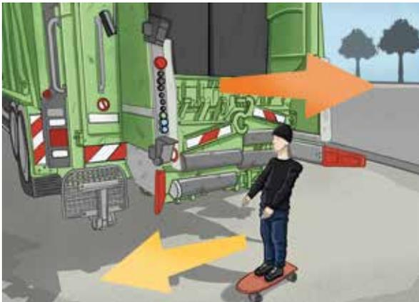
Abb. 1: Funktionstest eines RAS mit Testobjekt
