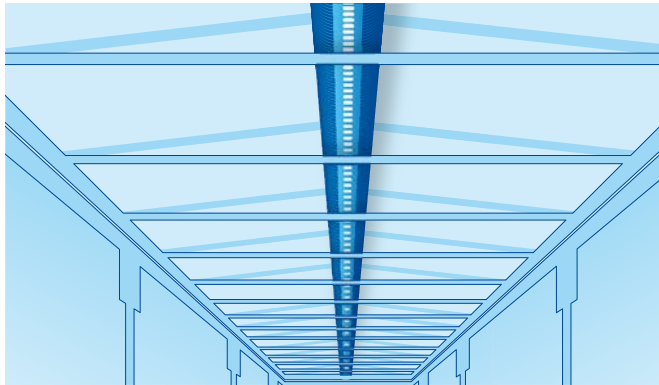
Ein Luftschlauch unter der Lkw-Plane sorgt dafür, dass sich Wasser nicht ansammeln kann.
