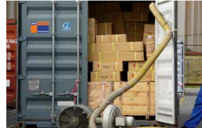
Vorbereitung einer technischen Belüftung
