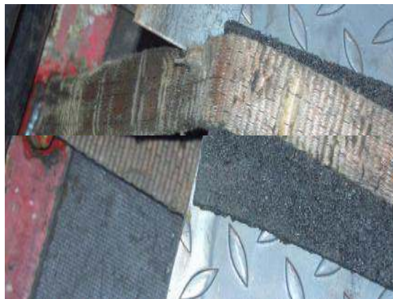
Abb. 31: Ablegereifer Gurt mit Antirutschmatte als Kantenschutz
