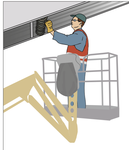
Arbeiten an Förderbändern nur im Stillstand
