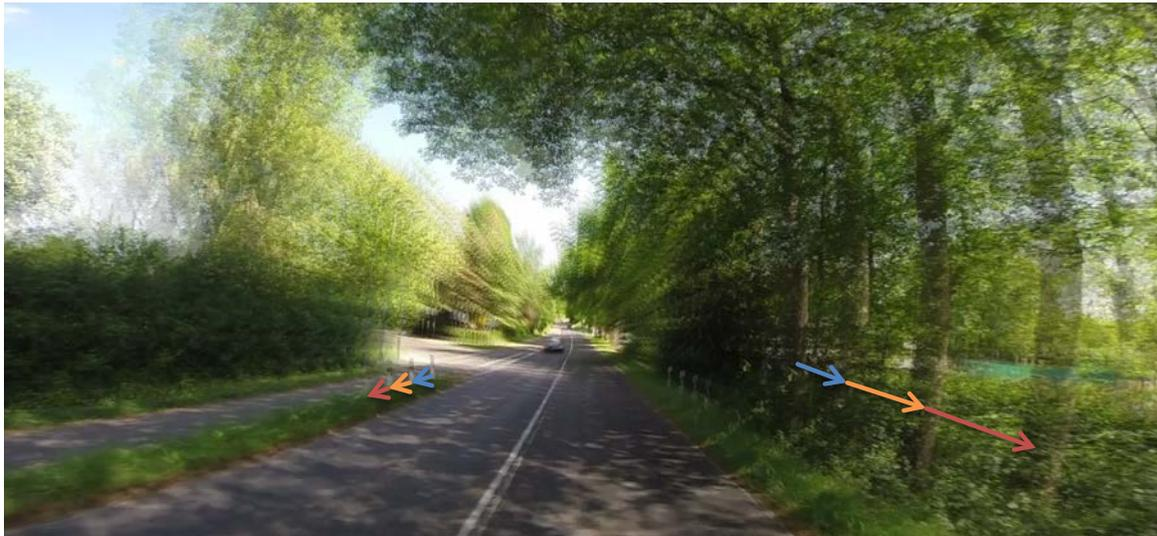
**Abbildung 53: Optischer Fluss am Beispiel von vier überlagerten Bildern**
