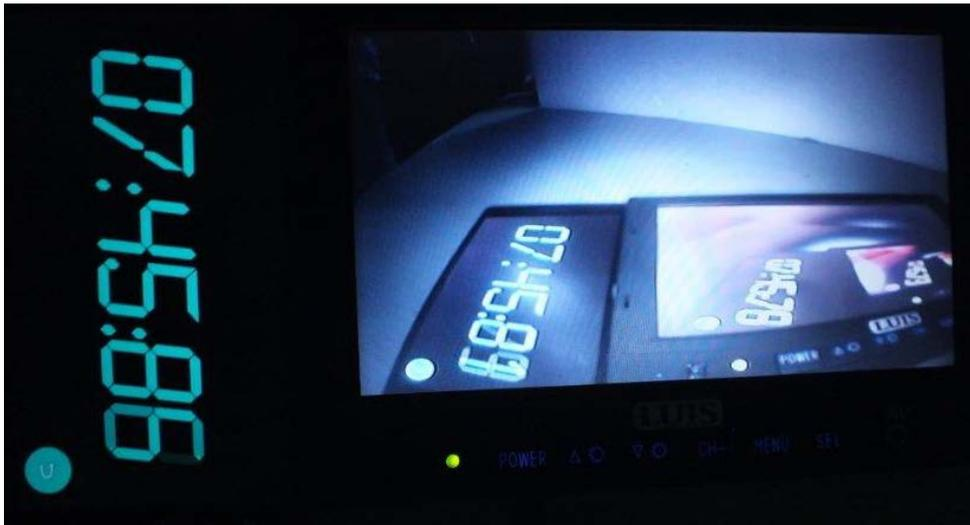
Abbildung 64: Foto einer Stoppuhr (07:45:86 – links) und eines Monitors. Im Monitor ist die Abbildung der Stoppuhr (07:45:81 – mitte) und die Abbildung des Monitors (07:45:78 – links) sichtbar.
