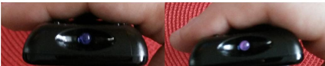
Abbildung 57: Fernbedienung mit einem Handy fotografiert: links ohne gedrückte Taste, rechts mit gedrückter Taste
