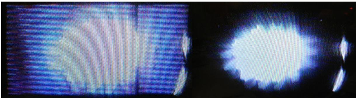
**Abbildung 52:** Aufnahmen eines Monitors eines KMS in der EMV-Kammer. Rechts unbeeinflusst, links beeinflusst mit 156 MHz und 20 V/m Feldstärke
