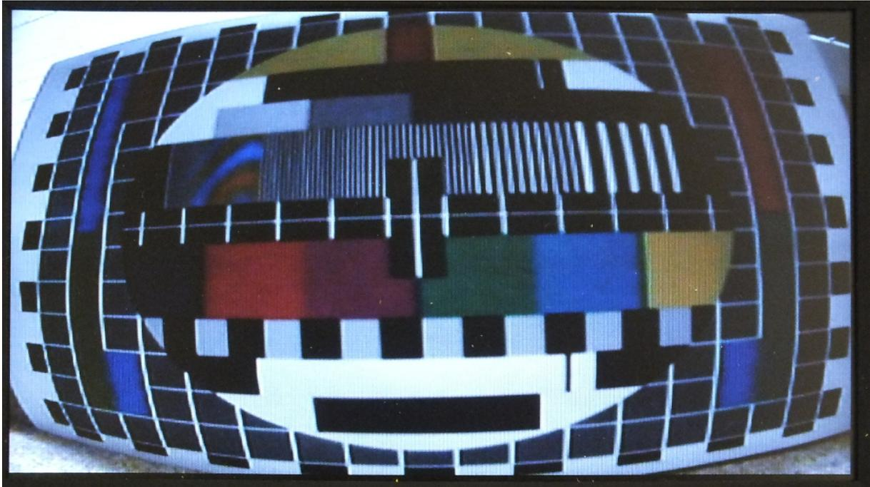
Abbildung 56: Aufnahme eines Testmusters mit einem KMS, deutlich wahrnehmbarer Kisseneffekt
