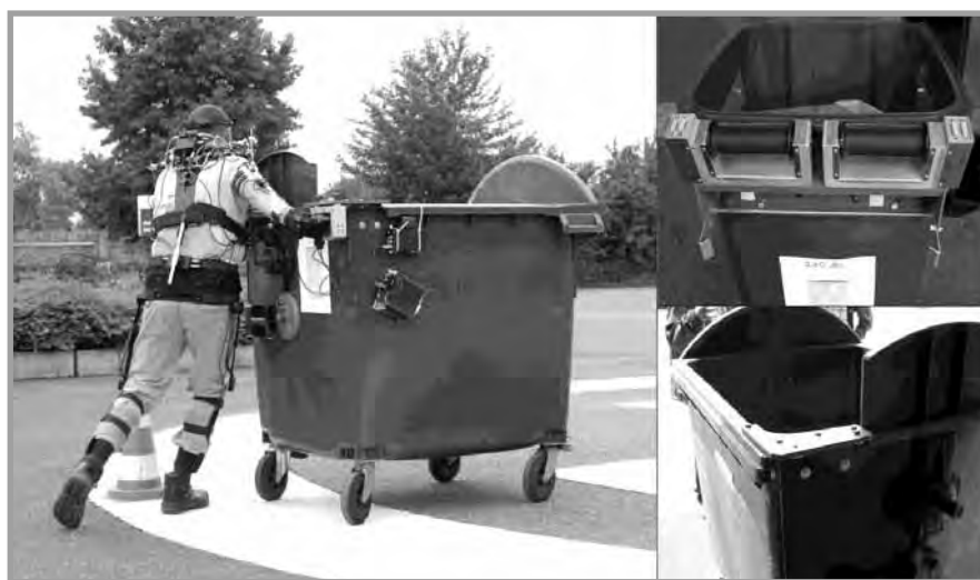
Bild 1: Messsystem zur computerunterstützten Erfassung und Langzeitanalyse (CUELA) zum Bestimmen der Rumpfhaltungen (l.) und Befestigung der eingesetzten Kraftmessgriffe zum Erfassen der Aktionskräfte (r.)
