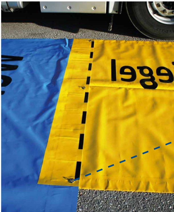
Bild 5: Drehverschlüsse der gelben Plane, die durch die Ösen der blauen Plane gesteckt werden.
