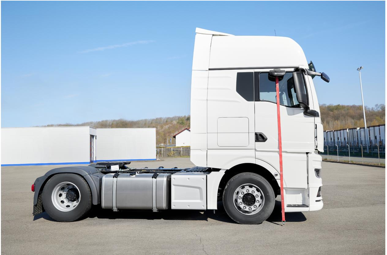
Öffnen Sie das Fenster auf der Beifahrerseite und hängen Sie den Zurring so weit hinaus, bis der Haken kurz über dem Boden hängt. Positionieren Sie den Ring mittig zum Anfahrspiegel und klemmen Sie ihn durch Schließen des Fensters leicht fest.
