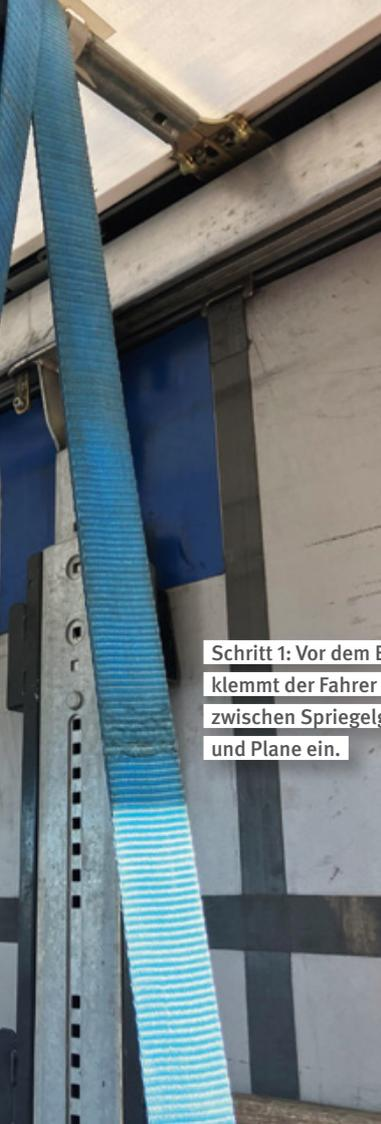
Schritt 1: Vor dem Beladen klemmt der Fahrer die Gurte zwischen Spriegelgestell und Plane ein.
