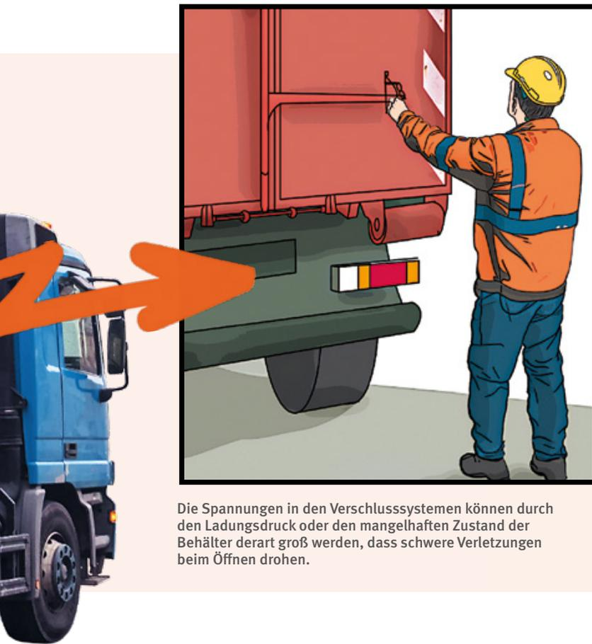
Die Spannungen in den Verschlusssystemen können durch den Ladungsdruck oder den mangelhaften Zustand der Behälter derart groß werden, dass schwere Verletzungen beim Öffnen drohen.
