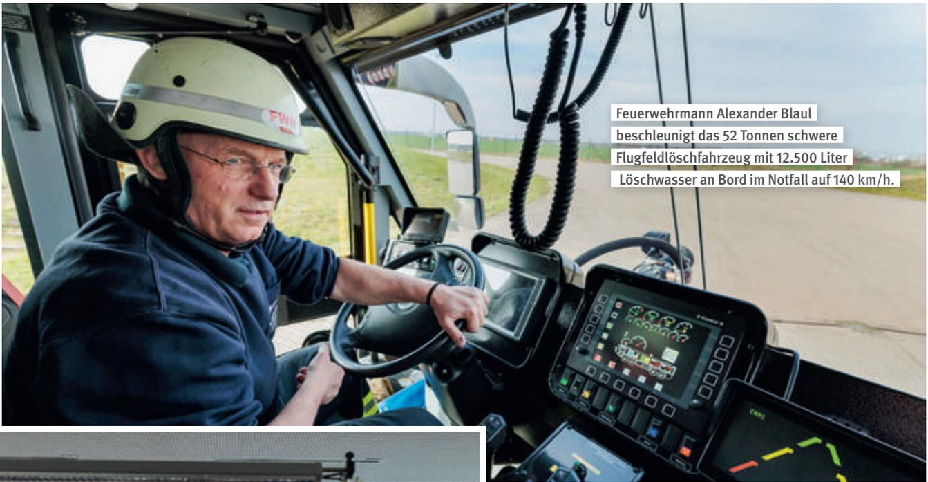
Feuerwehrmann Alexander Blaul beschleunigt das 52 Tonnen schwere Flugfeldlöschfahrzeug mit 12.500 Liter Löschwasser an Bord im Notfall auf 140 km/h.
