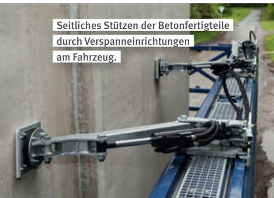
Seitliches Stützen der Betonfertigteile durch Verspanneinrichtungen am Fahrzeug.
