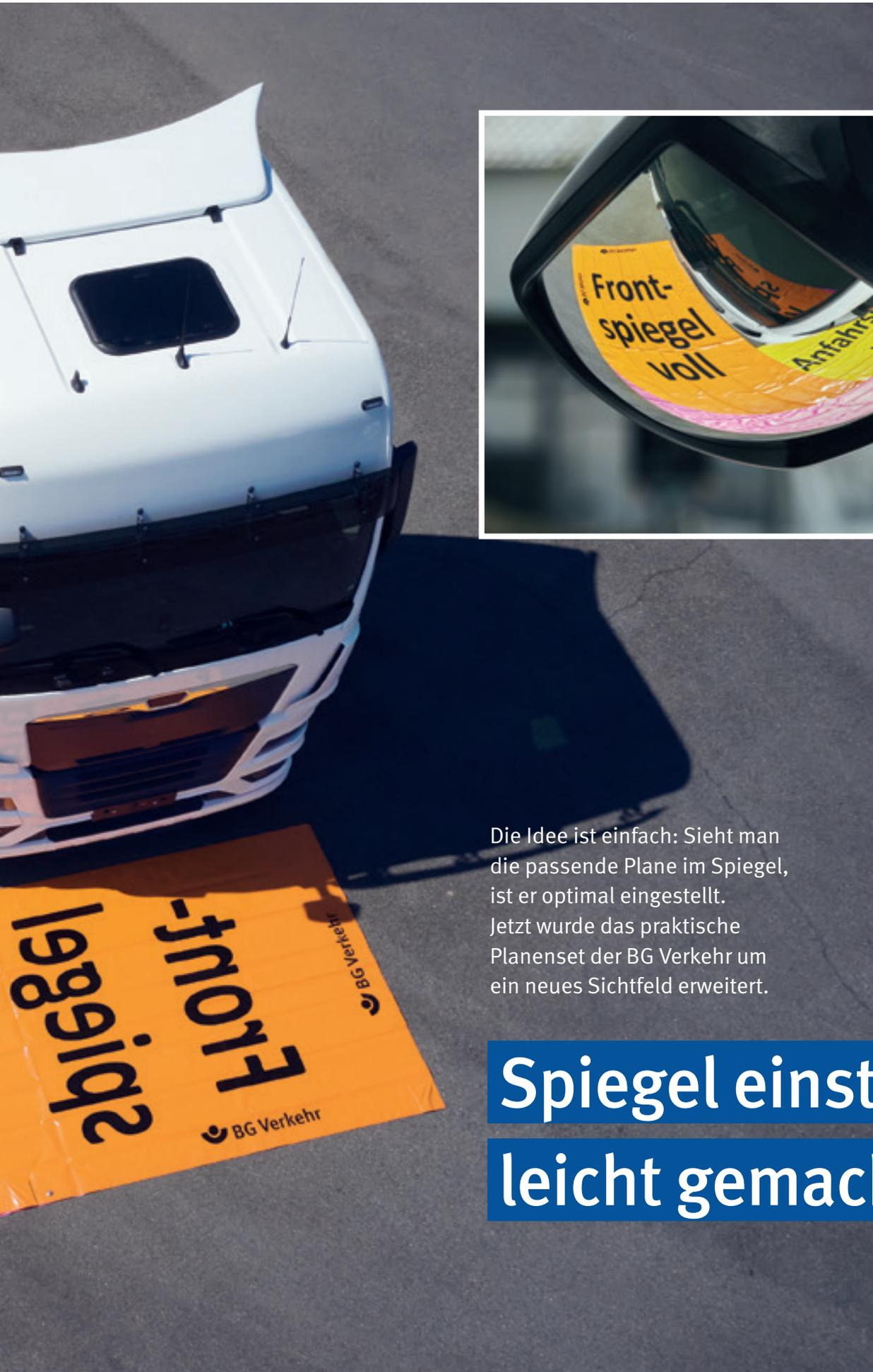
Die Idee ist einfach: Sieht man die passende Plane im Spiegel, ist er optimal eingestellt. Jetzt wurde das praktische Planenset der BG Verkehr um ein neues Sichtfeld erweitert.
