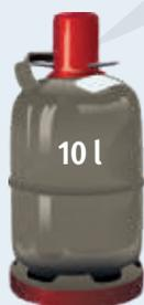
Ein Liter Propan ergibt gasförmig ca. 260 Liter, bei Butan ca. 220 Liter Volumen. Ein Gas-Luft-Gemisch mit einem Anteil von zwei bis zehn Prozent Gas ist explosibel.
