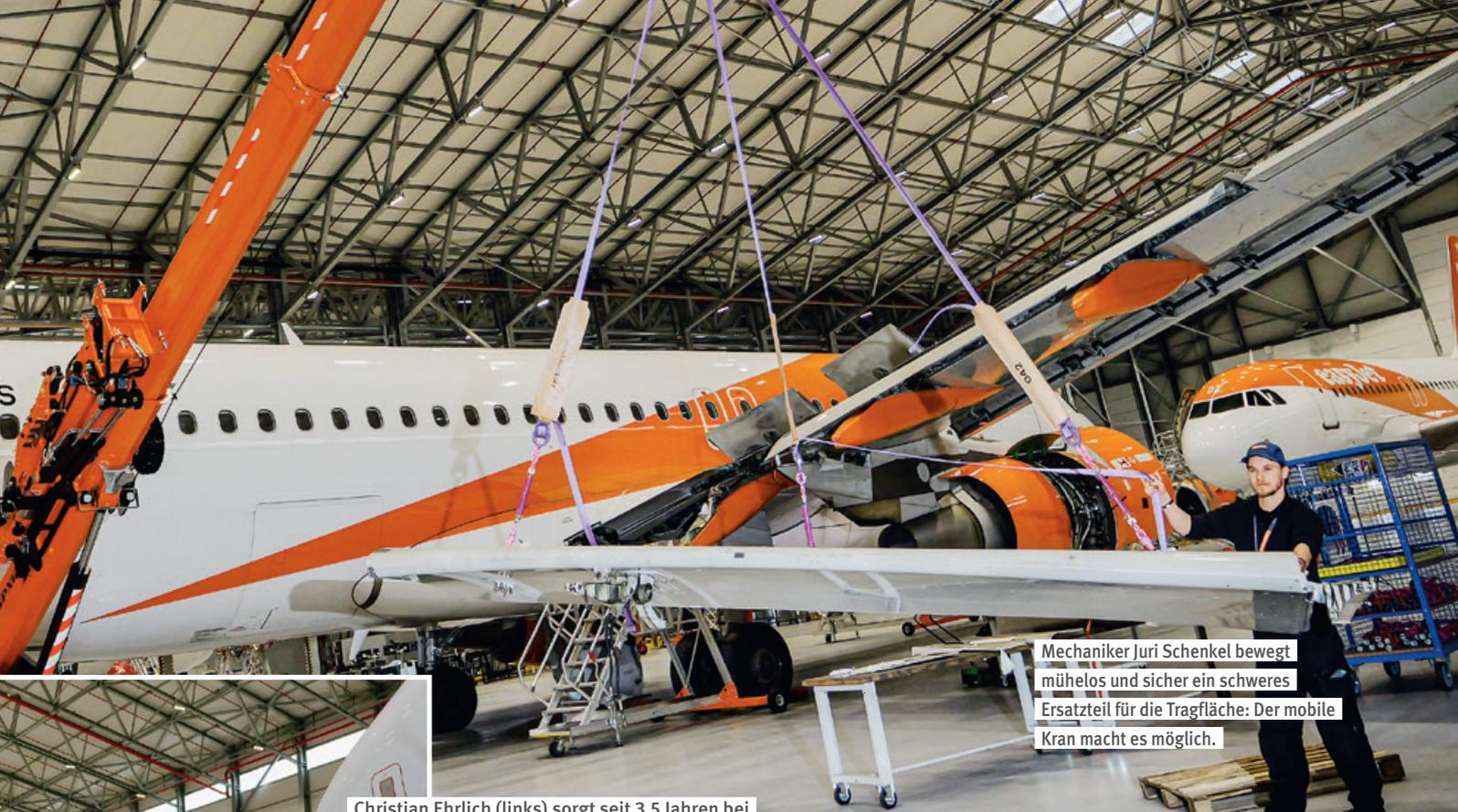
Mechaniker Juri Schenkel bewegt mühelos und sicher ein schweres Ersatzteil für die Tragfläche: Der mobile Kran macht es möglich.
