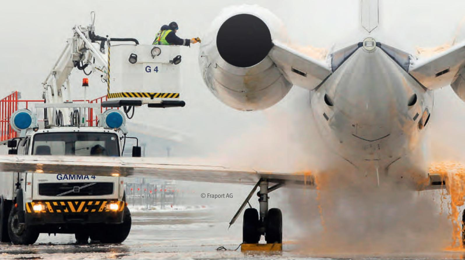
lässt aber genug Spielraum zum Arbeiten. In einer geschlossenen Kabine ist der Bediener etwas besser geschützt und weniger PSA ist als Schutzmaßnahme erforderlich.
