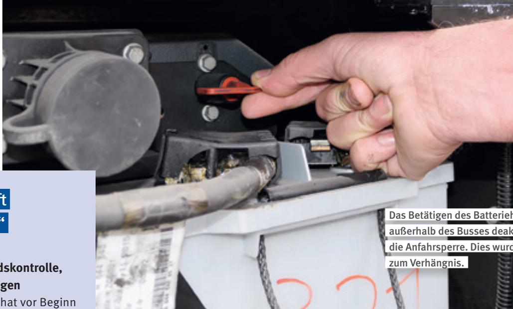
Das Betätigen des Batterie Hauptschalters außerhalb des Busses deaktiviert auch die Anfahrsperrung. Dies wurde dem Fahrer zum Verhängnis.
