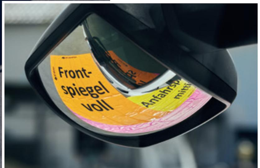
muss für Fahrzeuge, die ab dem 1. Juli 2016 erstmalig in Betrieb genommen wurden, eingesehen werden können. Eine weitere Bedingung ist, dass sich der Anfahrspiegel oder seine Einfassung mindestens 2,4 Meter über dem Boden befindet.
