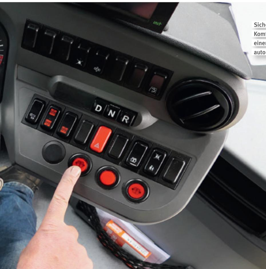
Sicherheit für die Fahrgäste und Komfort für den Fahrer: Beim Öffnen einer Tür wird die Anfahrsperrung automatisch aktiviert.
